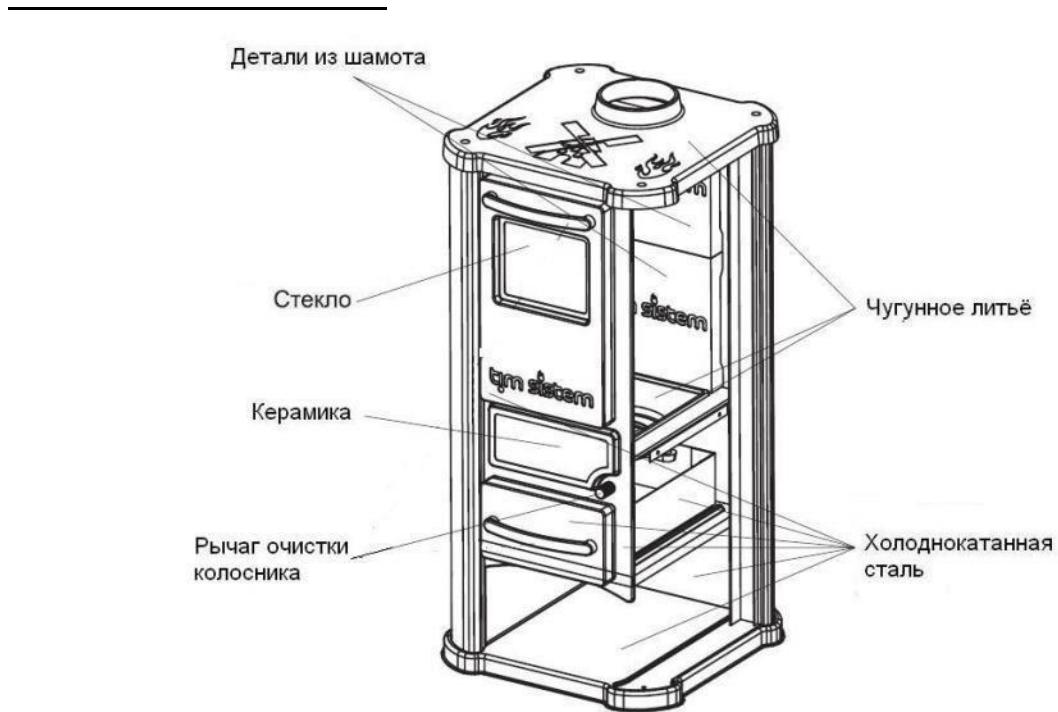
Размеры – 780(в) x 390(ш) x 390(г) Диаметр дымохода – 120 мм;
