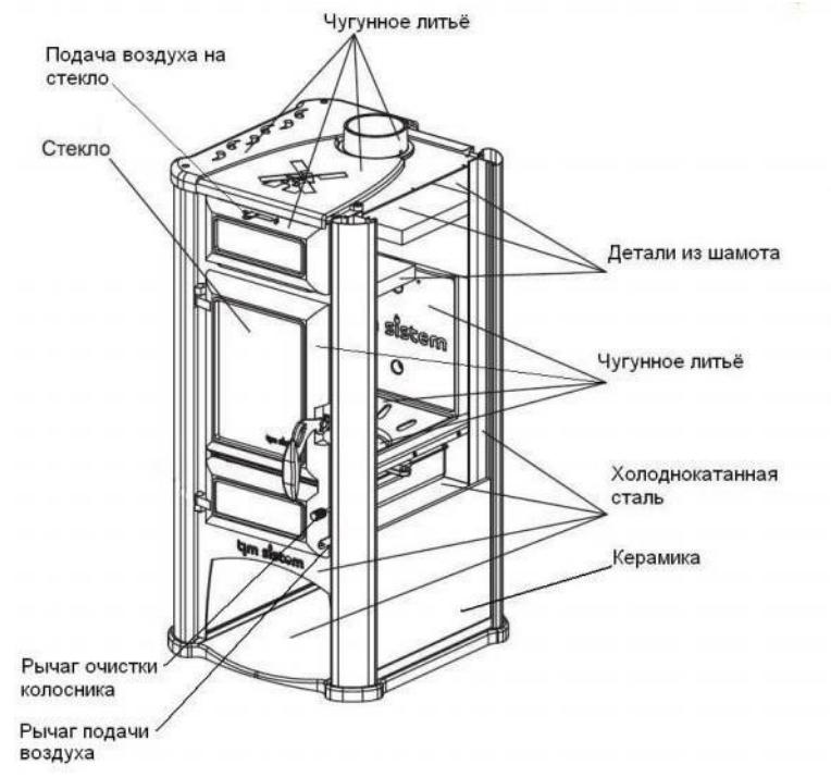
Размеры – 785(в) x 378(ш) x 378(г) Диаметр дымохода – 120 мм;
