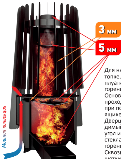
Рис. 3 Устройство и работа печи
