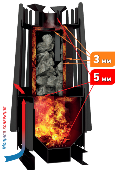
Рис. 4 Устройство и работа печи
