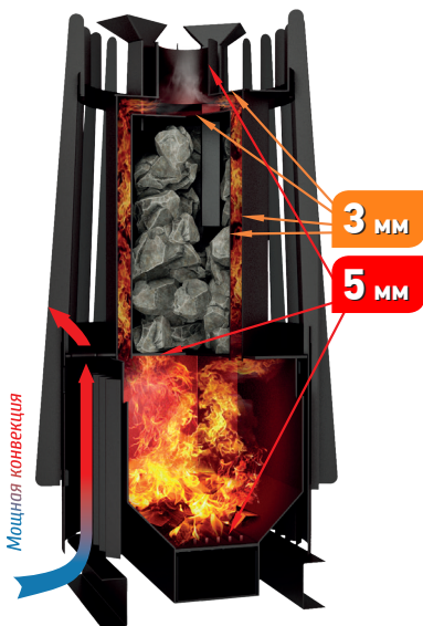
Рис. 3 Устройство и работа печи
