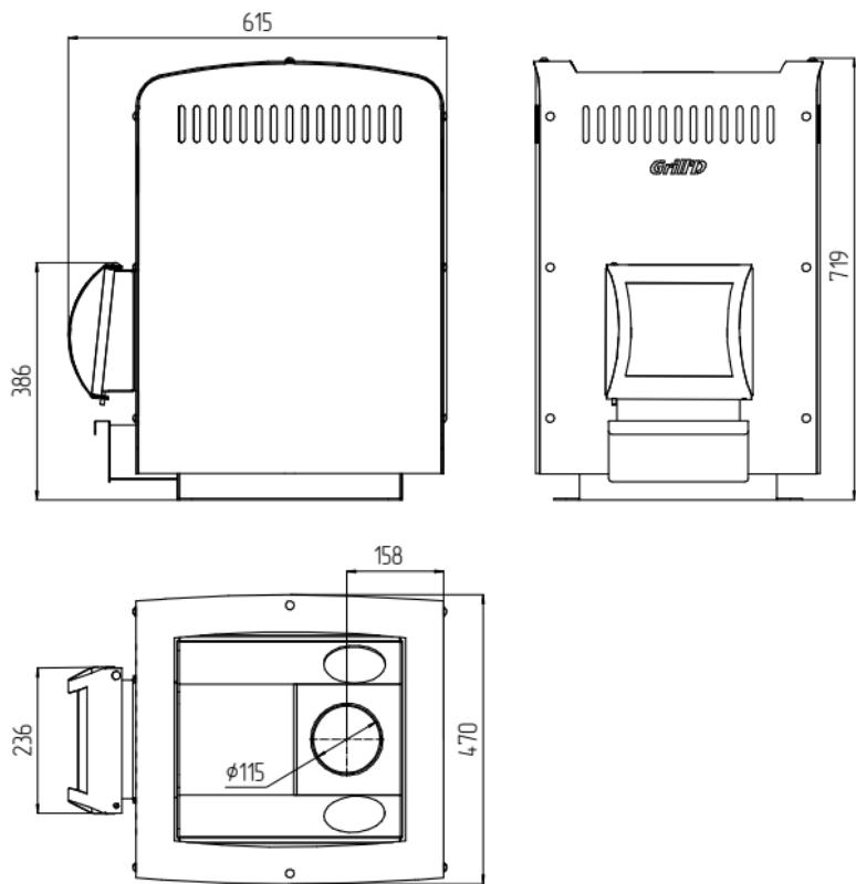
Рис. 1 Размерные характеристики печи «Grill'D» Optima 150 Short
