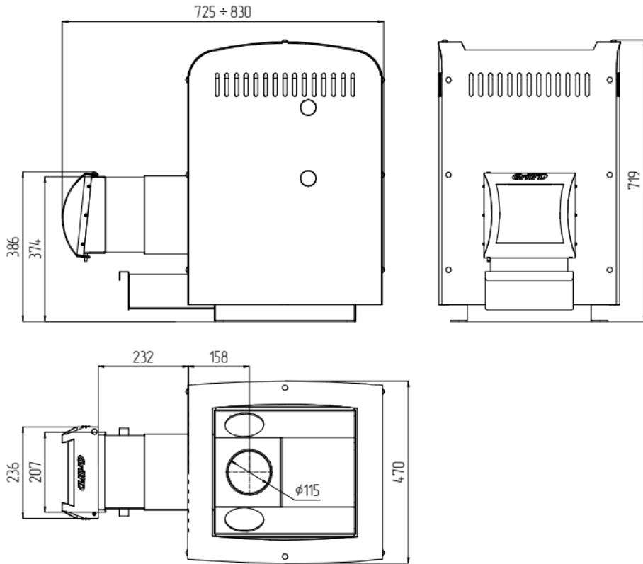
**Рис. 2** Размерные характеристики печи «Grill'D» Optima 150 Long
