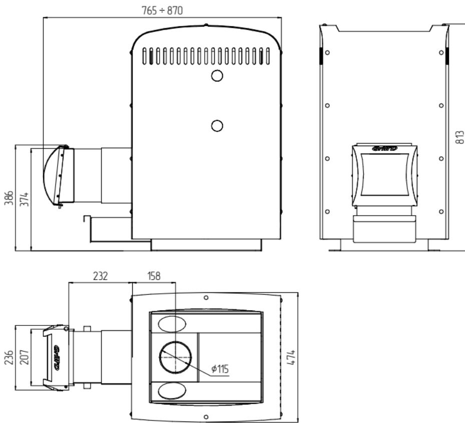
Рис. 4 Размерные характеристики печи «Grill'D» Optima 250 Long
