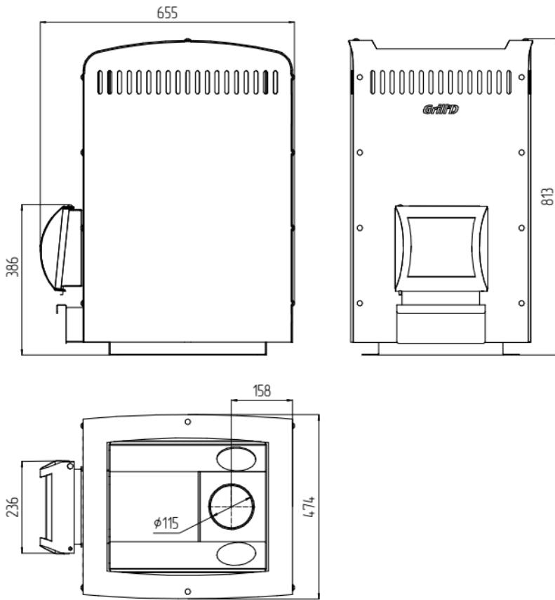
Рис. 3 Размерные характеристики печи «Grill'D» Optima 250 Short
