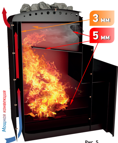
Рис. 5 Устройство и работа печи
